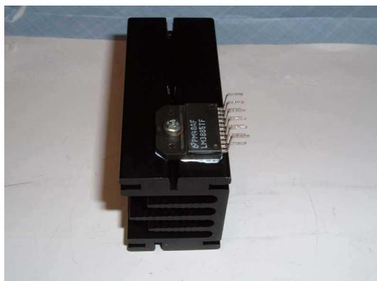
**Fig6 LM3886 fissato al dissipatore**
