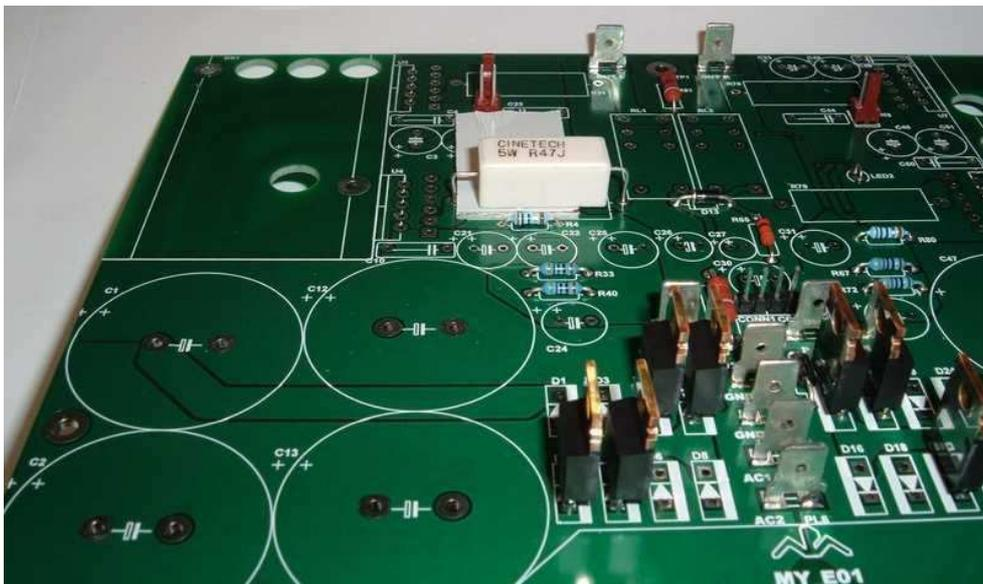
**Fig4** Particolare montaggio diodi e resistenze di potenza
