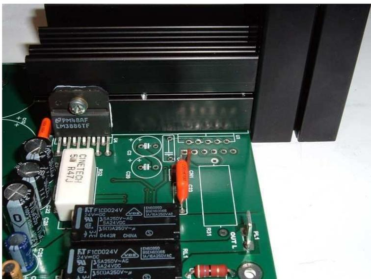
**Fig8 verifica allineamento PCB-dissipatore (laterale)**
