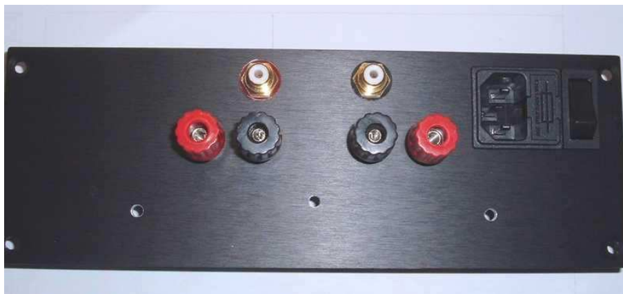
Fig3 pannello posteriore forato e con i connettori in posizione, vista lato esterno
