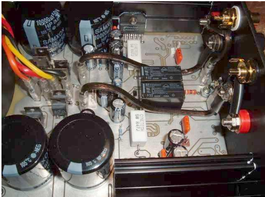
Fig8 posizione dei cavi di potenza
