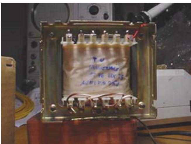
**Trasformatore universale "audiofaidate"**: è un trasformatore controcorrente. Il progetto è estremamente ragionato. Riesce a lavorare (sistemando i lamierini) sia in amplificatori asimmetrici che in push-pull. E' velocemente settabile a 5K, 3,5K, 2,2K su 6,3 ohm. Rapporto di trasformazione (5Kohm-6,3 ohm) 28,3, resistenza 177 ohm. Ha tre padri: Ivo, Mrttg, e Plovati. Una più autorevole e dettagliata descrizione del progetto sarà, ovviamente a loro carico
