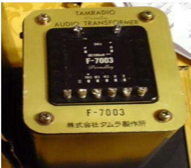
**Tamura F 7003**: unico a essere ancora regolarmente in commercio. Bel trasformatore ben più importante come stazza del #10429 . Sempre in permalloy anche se con meno nickel (38%), 5K primario, Secondario 4-8-16 ohm. Rapporto di trasformazione 24,9 (5Kohm-8ohm) Induttanza primaria confortante (dichiarata 30H) e resistenza del primario in cc. 184 ohm. Prezzo 460€
