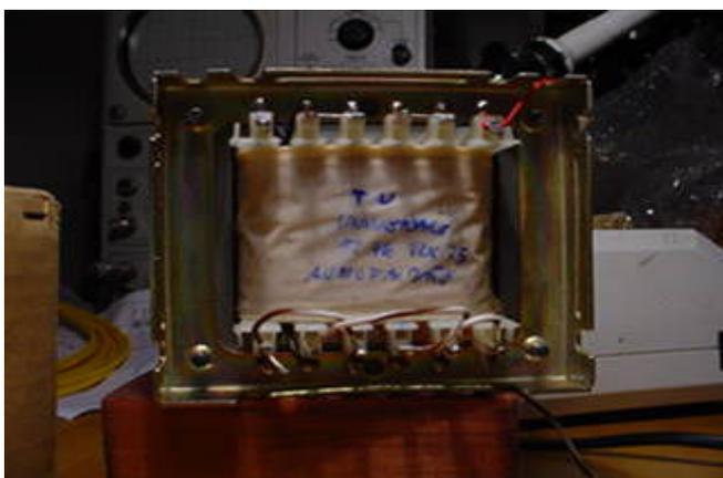
Trasformatore universale "audiofai date": è un trasformatore controcorrente. Il progetto è estremamente ragionato. Riesce a lavorare (sistemando i lamierini) sia in amplificatori asimmetrici che in push-pull. E' velocemente settabile a 5K, 3,5K, 2,2K su 6,3 ohm. Rapporto di trasformazione (5Kohm-6,3 ohm) 28,3, resistenza 177 ohm. Ha tre padri: Ivo, Mrttg, e Plovati. Una più autorevole e dettagliata descrizione del progetto sarà, ovviamente a loro carico
