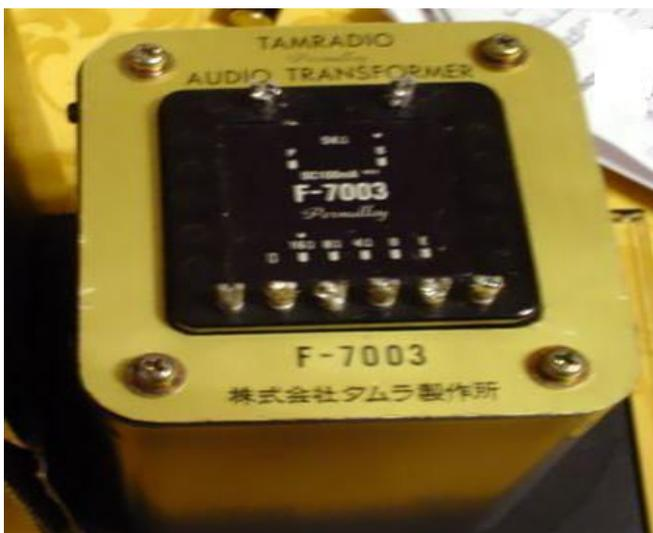
Tamura F 7003: unico a essere ancora regolarmente in commercio. Bel trasformatore ben più importante come stazza del #10429 . Sempre in permalloy anche se con meno nickel (38%), 5K primario, Secondario 4-8-16 ohm. Rapporto di trasformazione 24,9 (5Kohm-8ohm) Induttanza primaria confortante (dichiarata 30H) e resistenza del primario in cc. 184 ohm. Prezzo 460€
